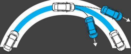
New Honda BR-V menggunakan teknologi Vehicle Stability Assist untuk membantu mencegah gejala oversteer dan understeer.
