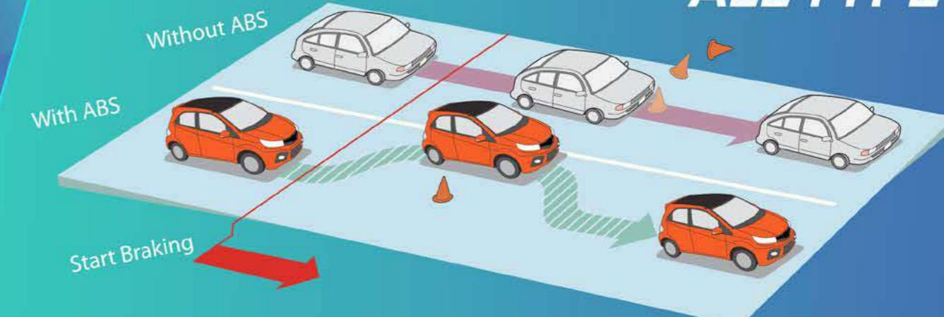
ABS (Anti-Lock Braking System) Mencegah penguncian roda pada saat pengereman mendadak.
